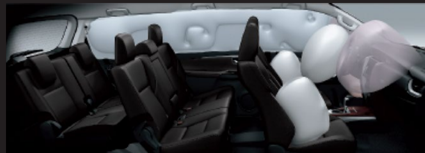
7 AIRBAGS: FRONTALES (X2), DE RODILLA (CONDUCTOR), LATERALES (X2) Y DE CORTINA (X2)
