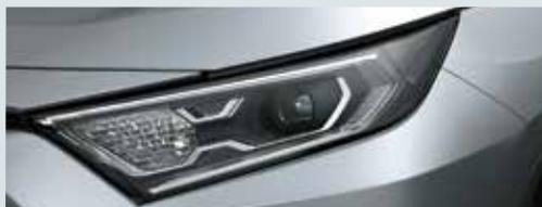
FAROS DELANTEROS BI-LED CON NIVELACIÓN AUTOMÁTICA EN ALTURA.
