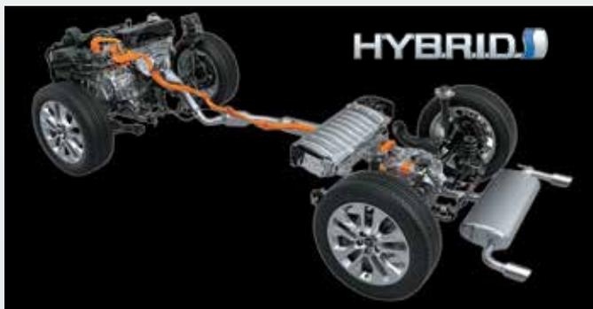
El nuevo sistema híbrido auto-recargable de Toyota RAV4 está compuesto por **dos motores** (naftero + eléctrico) que trabajan conjuntamente, otorgando una potencia total de **222 CV** para la versión AWD y **218 CV** para las versiones 4x2.
