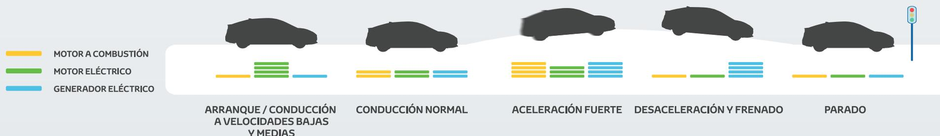
A diferencia de los vehículos convencionales que funcionan gracias a un motor de combustión interna, un auto híbrido es impulsado por la energía que le proveen sus dos motores, uno naftero y otro eléctrico.
