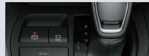
FRENO DE ESTACIONAMIENTO ELÉCTRICO CON FUNCIÓN "AUTO-HOLD".
